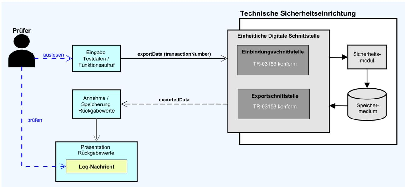
Abbildung 4: Zweite Phase in Bezug auf das Testen der Funktion startTransaction
