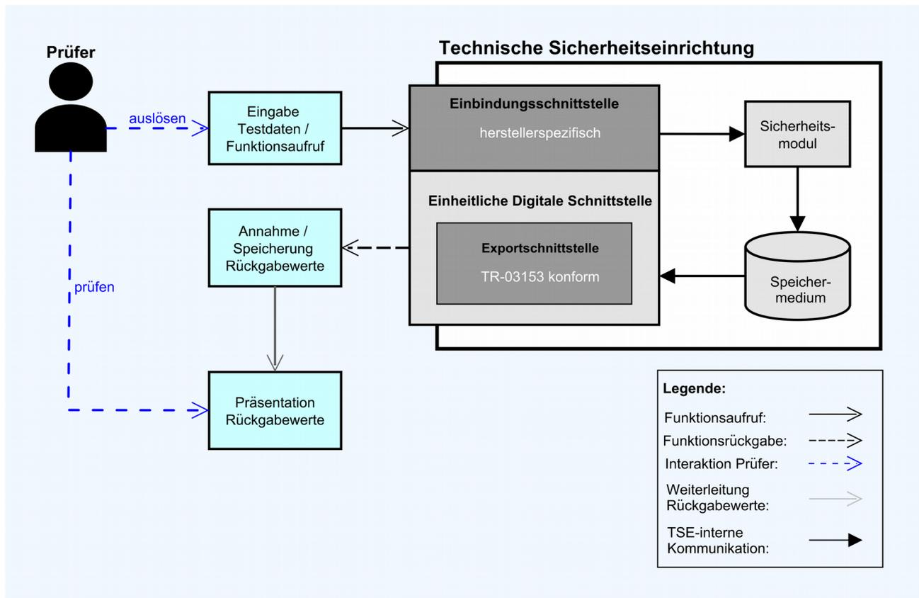
Abbildung 2: Testdurchführung für eine TSE mit einer herstellerspezifischen Einbindungsschnittstelle
